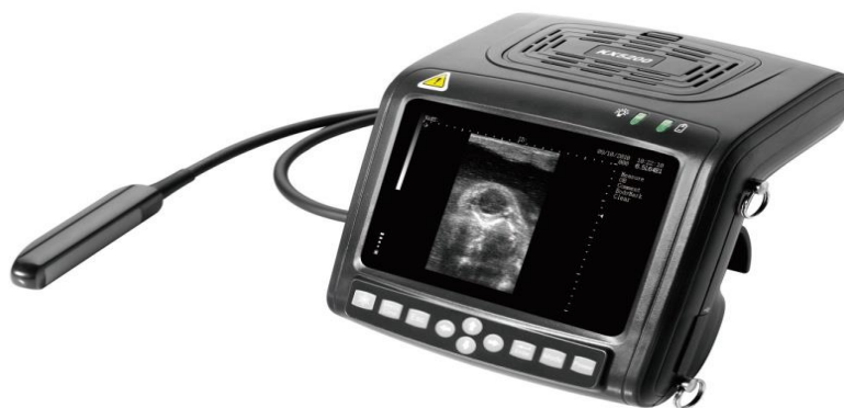
Рис. 2.1. Прилад для ультразвукового дослідження «KX5200»
