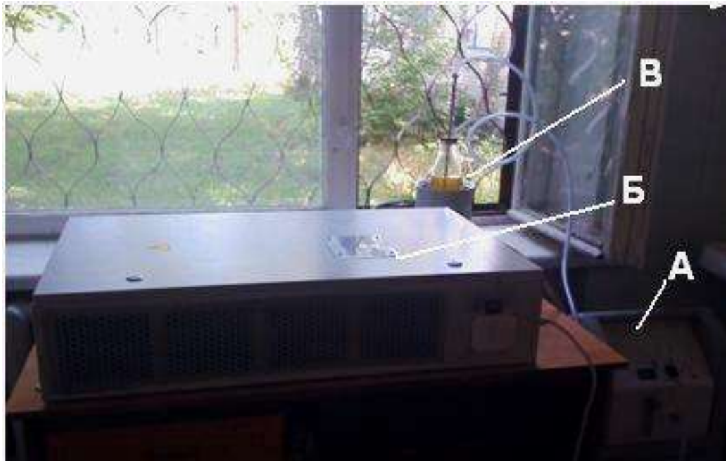
Рис. 3 2.1. Генератор кисню та озонатор: а) генератор; б) озонатор; в) барбітурація олії
