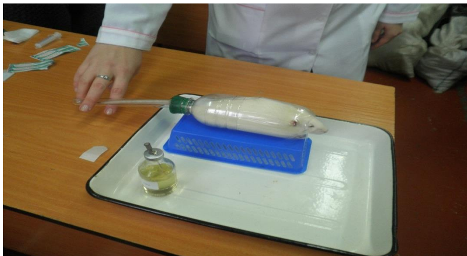
Рис. 2.3. Пристрій для визначення хронічної токсичності дезінфекційних засобів
