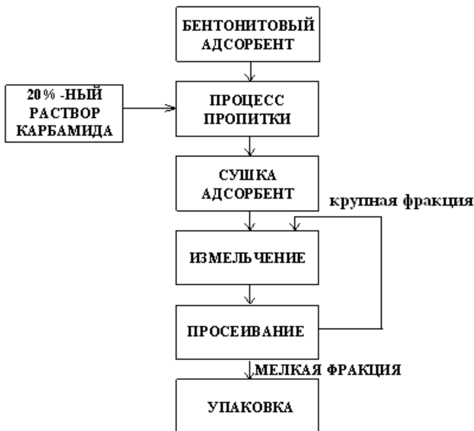
Рисунок 1. Схема производства адсорбента, модифицированного раствором карбамида
